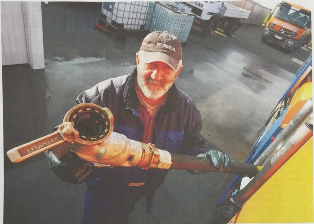
Um den Tank eines Kunden zu befüllen, wird die Zapfpistole, die Mitarbeiter Markus Zegar in Händen hält, an den Tankstutzen angeschlossen. Die Lastzüge verfügen über ein Fassungsvermögen von bis zu 32 000 Liter. FOTO: MATTHIAS VOIGT
